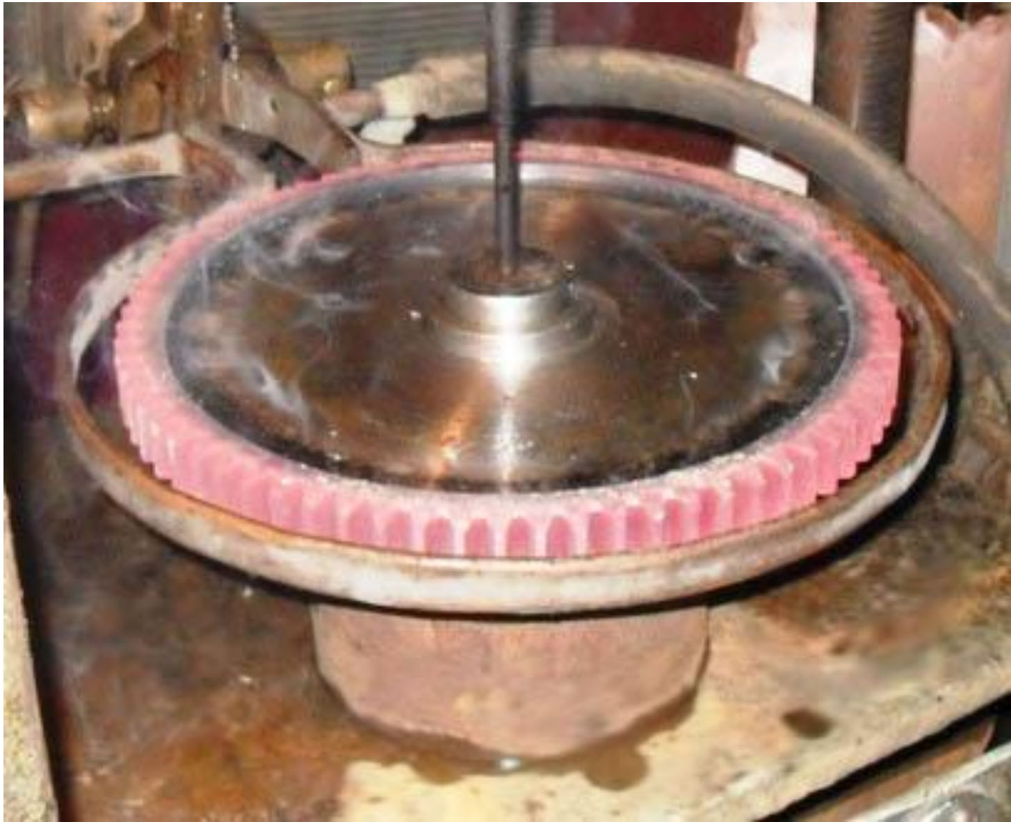
Закалка ТВЧ зубчатого колеса
