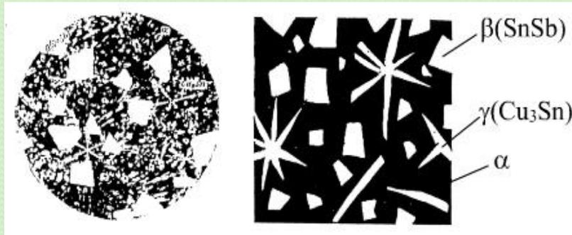
Оловянный баббит – Б83 (83 % Sn). Его структура состоит из твердых кристаллов SnSb и Cu<sub>3</sub>Sn, расположенных в мягкой пластичной основе, представляющей собой твердый раствор Sb и Cu в олове.
