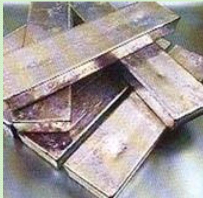
Цинковые антифрикционные сплавы используют для подшипников металлорежущих станков, прессов, прокатных станов. Их применяют либо в виде монометаллических вкладышей и втулок, либо биметаллических, нанося их на стальную ленту.
