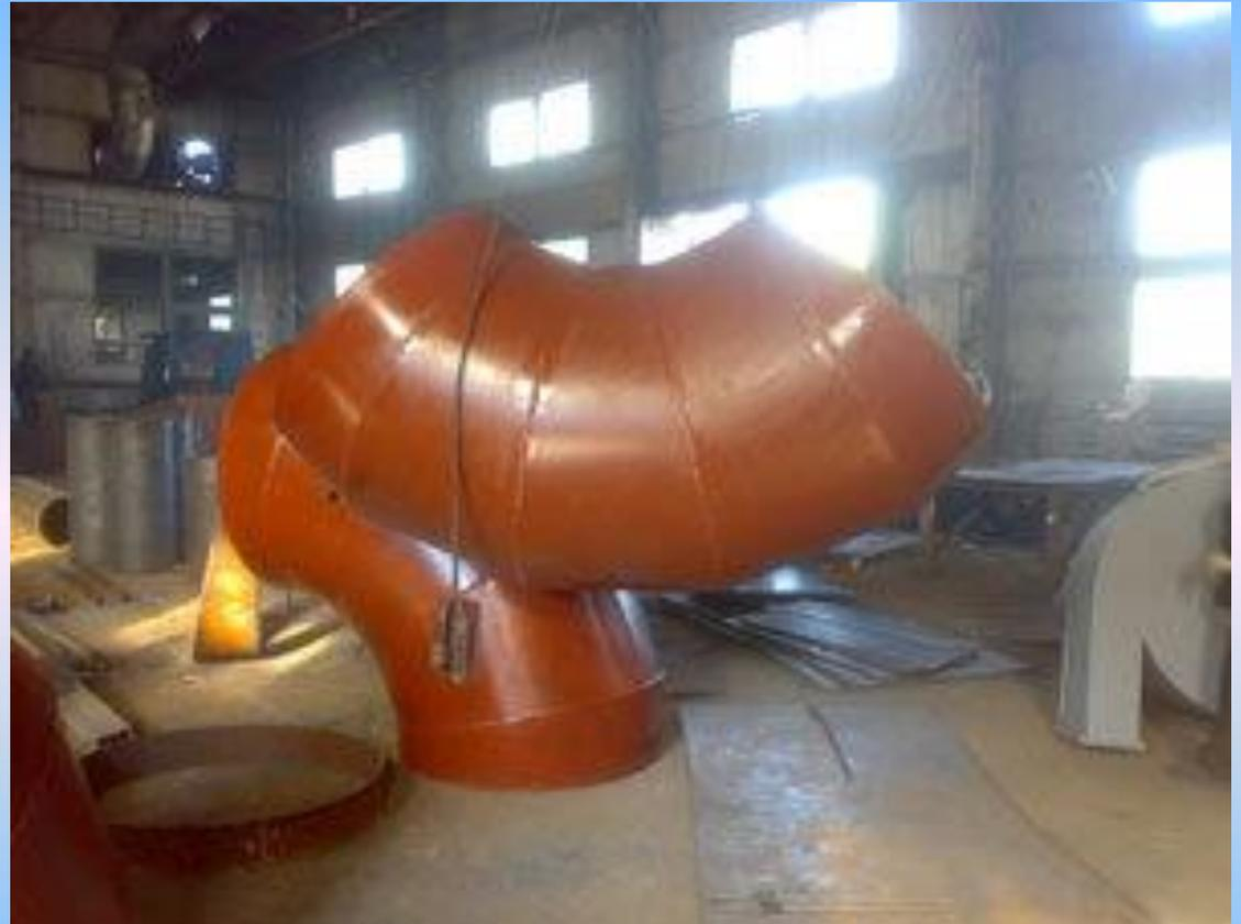
Детали трубопроводов из углеродистой стали
