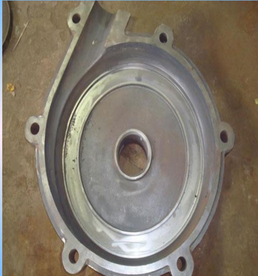
Маркируется серый чугун следующим образом: СЧ15, СЧ20 и т.д. (ГОСТ 1412-87). Буквы означают принадлежность к серому чугуну, цифры показывают предел прочности в МПа · 10<sup>-1</sup>. Например, чугун марки СЧ15:  $\sigma_{\text{в}} = 150$  МПа.
