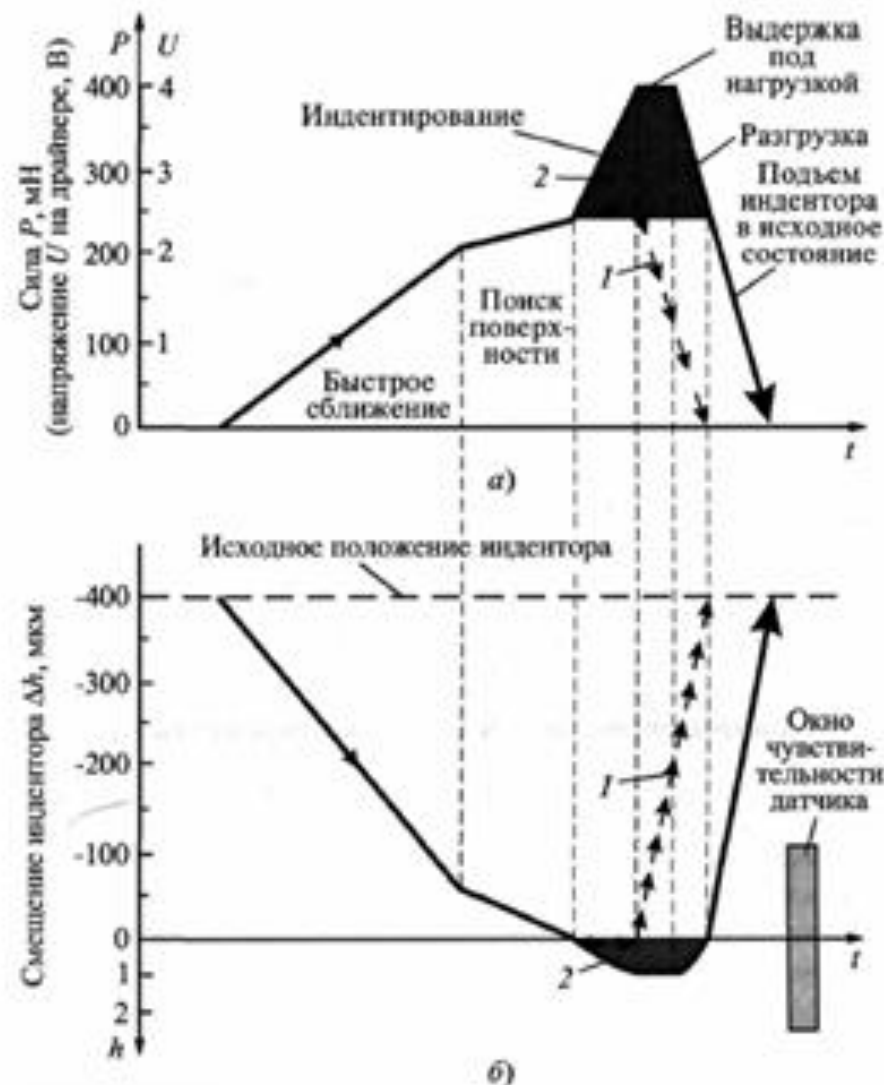
Рис.2. Кинетика изменения различных величин, характеризующих работу измерительной силовой головки:
