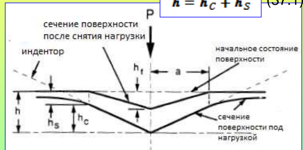
Схематическое изображение поперечного сечения процесса индентирования.
