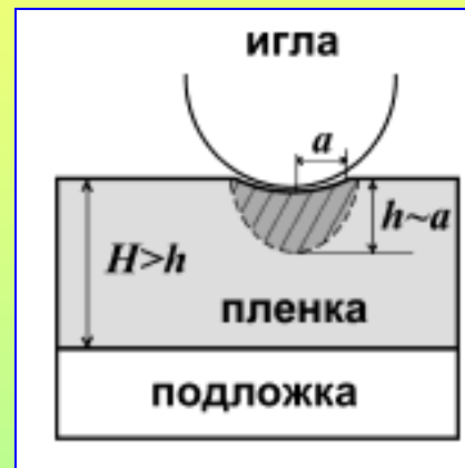
а Измерение твердости покрытия без влияния подложки
