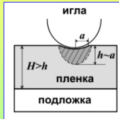
а Измерение твердости покрытия без влияния подложки
