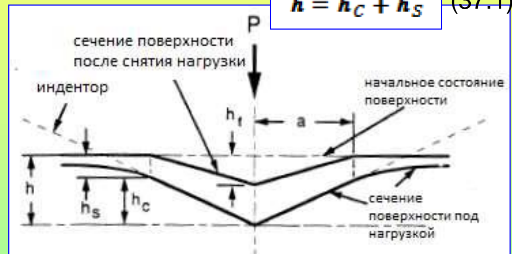
Схематическое изображение поперечного сечения процесса индентирования.
