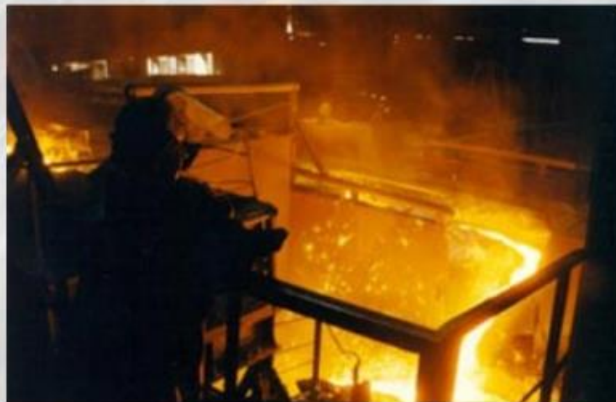
Разливка чугуна в изложницы.
