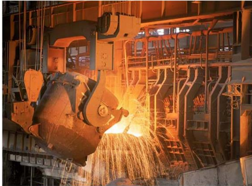
Заливка чугуна в мартеновскую печь
