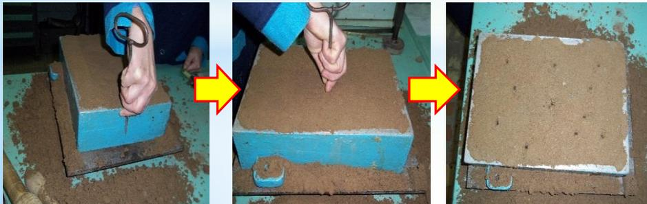
**Иглой накалывают вентиляционные каналы для выхода образовавшихся газов**
