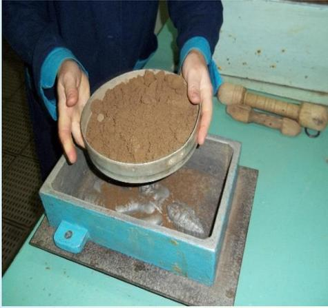
Просеянная через сито формовочная смесь должна полностью покрыть модель отливки
