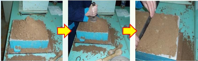
**Излишек формовочной смеси после уплотнения выравнивают линейкой вровень с кромками опоки.**
