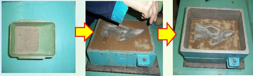
Затем нижнюю опоку поворачивают на  $180^{\circ}$  и посыпают песком, чтобы верхняя полуформа легко отделялась после полного формования
