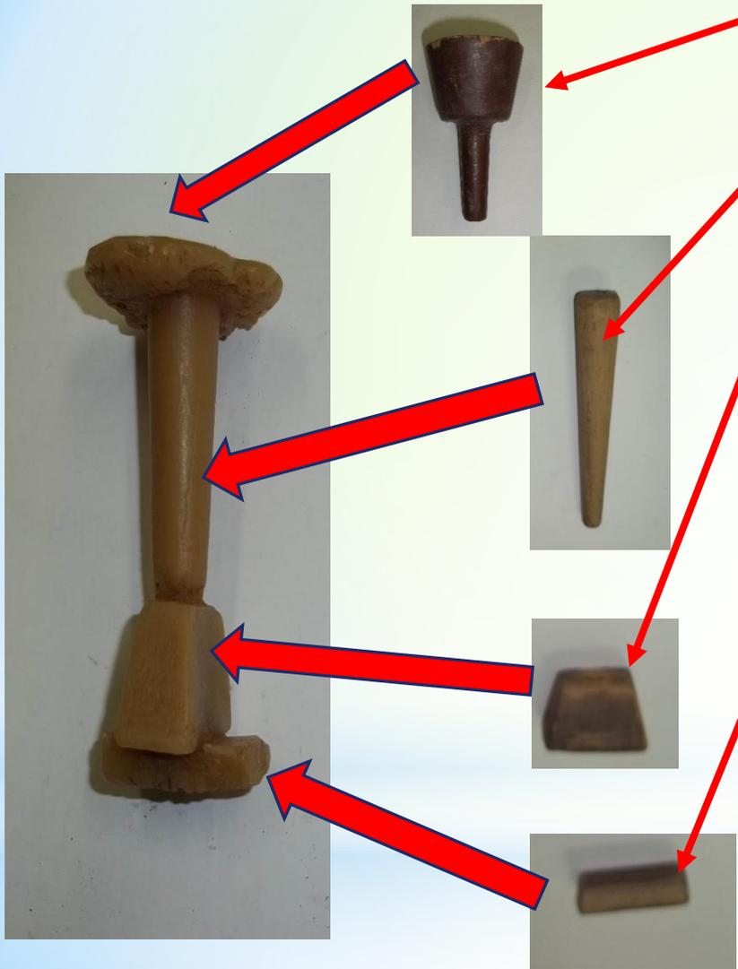
**Литниковая чаша** принимает напор струи металла и частично отделяет шлак.
