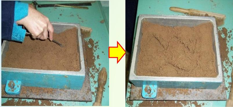
**Иглой между слоями песчано-глинистой смеси разрыхляют для сцепления со следующим слоем**
