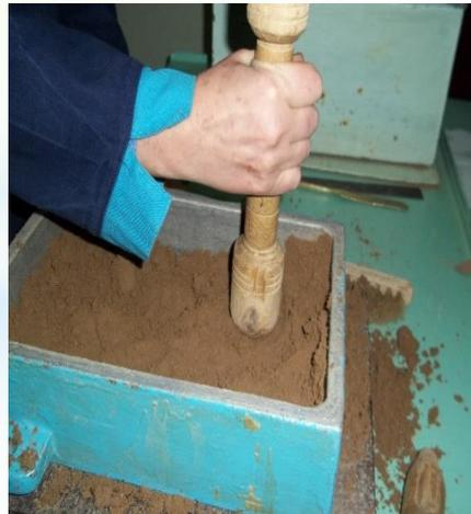
Для достижения равномерной плотности формы смесь засыпают в опоку слоями (50...75 мм) и уплотняют трамбовкой.
