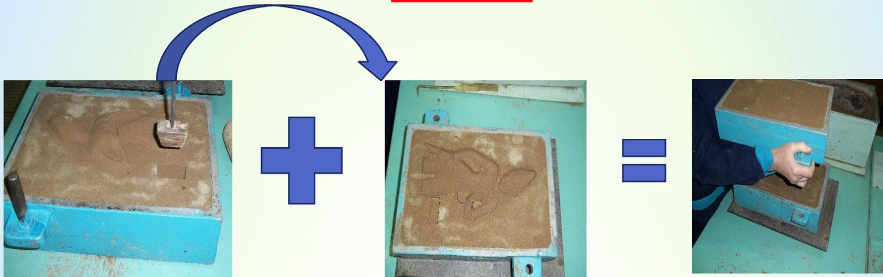
**Собранную форму заливают жидким металлом. После заливки формы металл определенное время охлаждается и затвердевает, после чего форма разрушается (выбивается) и из нее извлекают отливку.**
