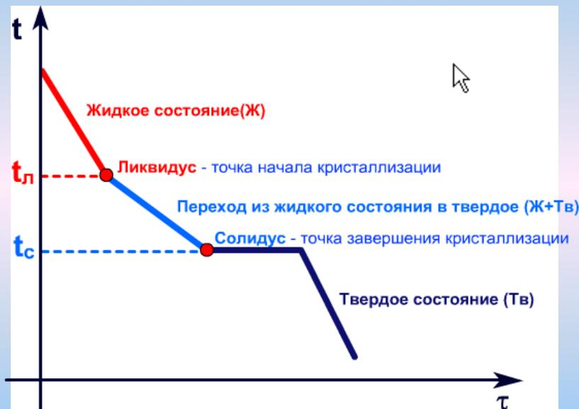
Критические точки – это температуры перехода сплава из одного фазового состояния в другое. К критическим относят температуры плавления сплава (кристаллизации), полиморфных превращений.
