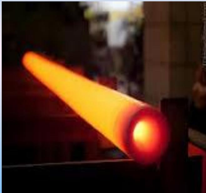
Для стали наиболее оптимальным интервалом температур для проведения горячей пластической деформации является температура 1000–1200 °С, когда снижается временное сопротивление  $\sigma_B$  и металл становится пластичным.
