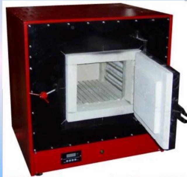
Печи для нагрева металла перед обработкой давлением классифицируются по таким признакам: по *источникам энергии* – на пламенные и электрические; по *назначению* – на кузнечные и для прокатного производства; по *принципу действия* – на камерные и методические.
