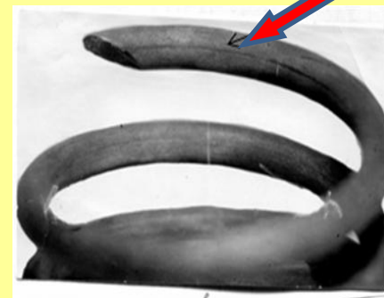
Волосовина на витке пружины
