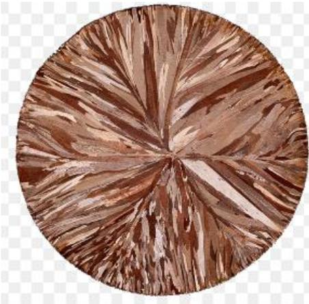
макроструктура литого образца медного сплава
