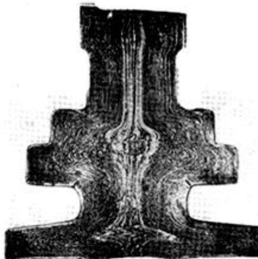
макроструктура блока шестерен
