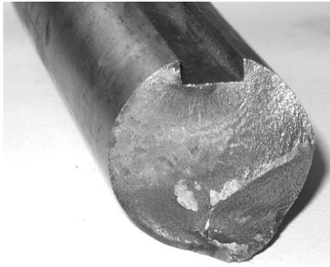
В деталях, работающих при многократных переменных, и, особенно, знакопеременных нагрузках имеет место усталостное разрушение.
