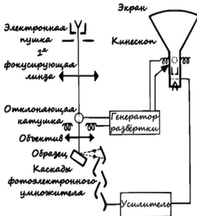
Рисунок 1 – Принципиальная схема РЭМ
