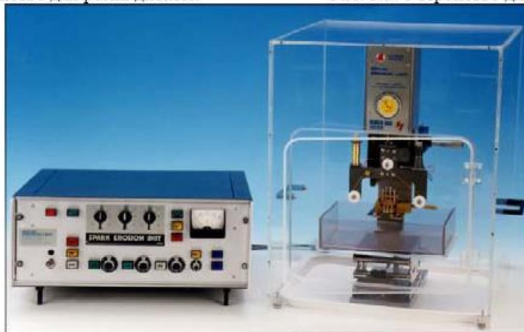
Рис. 5.4. Прибор для искровой резки.
