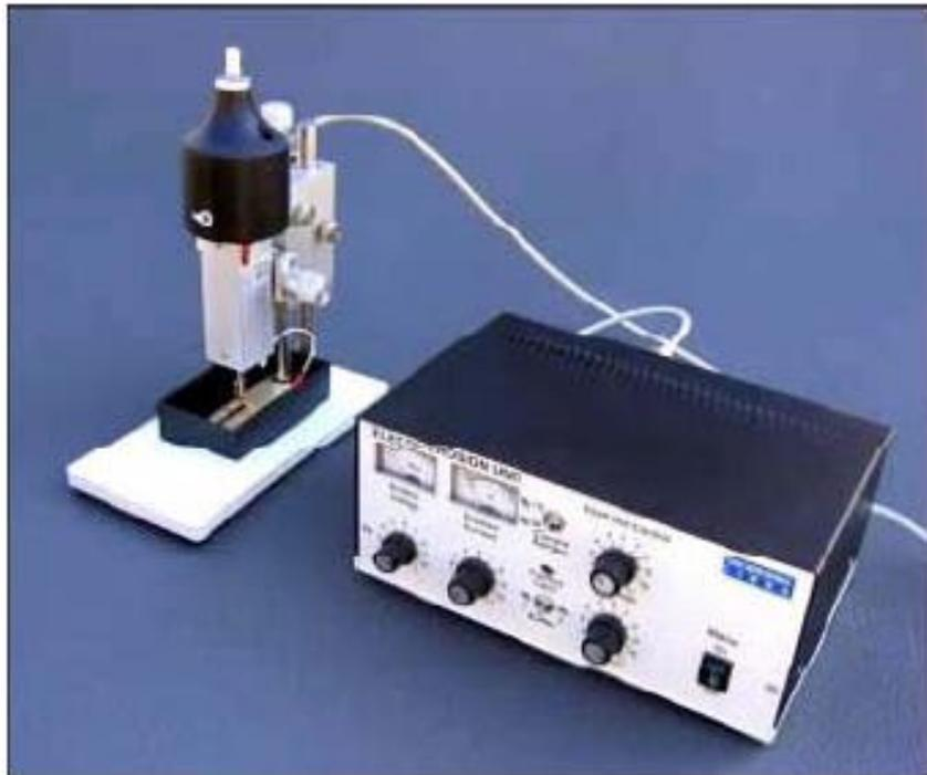
Рис. 5.5. Устройство для резки ультразвуком
