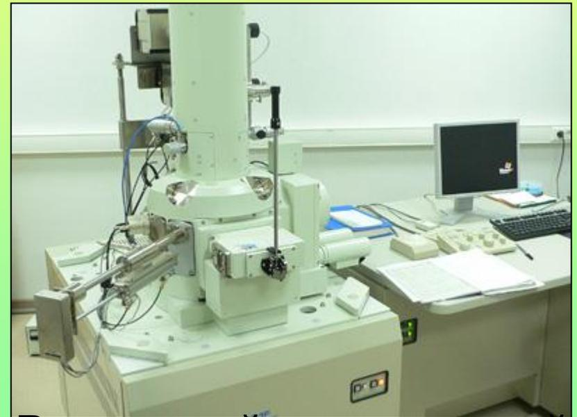
**Растровый электронный микроскоп JEOL JSM-7001F**
