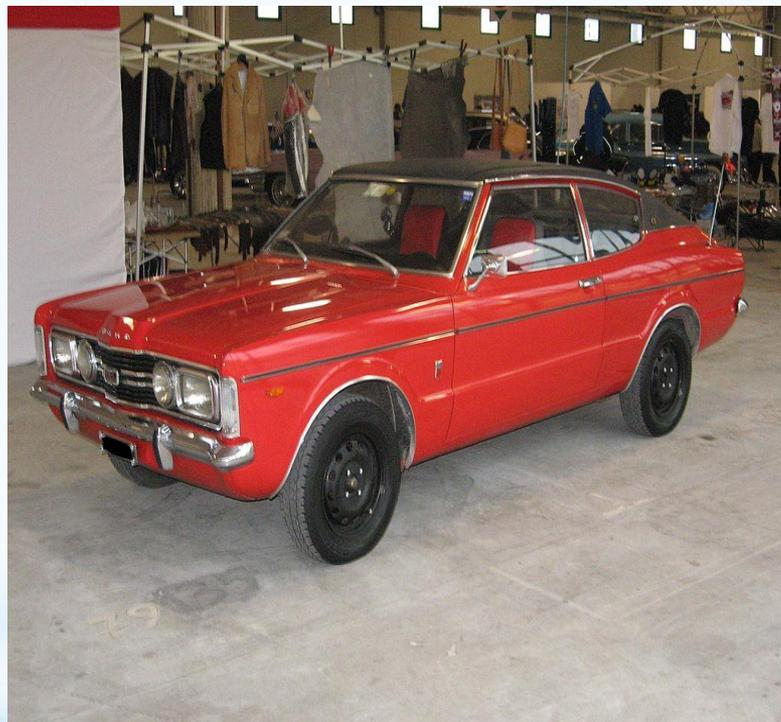
При небольшой высоте (1362 мм) силуэт автомобиля выглядел приземистым, что характерно для американских авто тех лет. Использование в дизайне автомобиля гнутых боковых стёкол без форточек стало возможно благодаря применению эффективной системы вентиляции и отопления.
