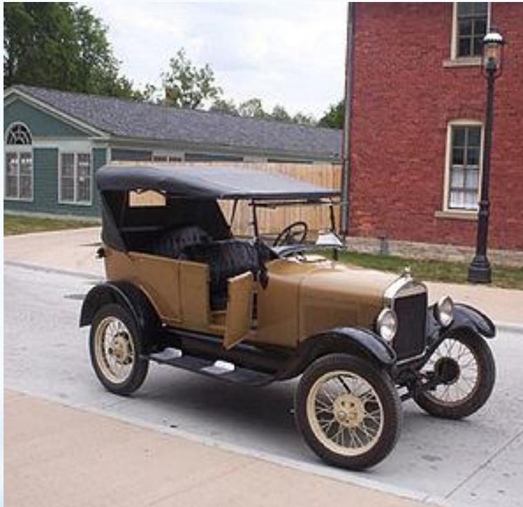
Автомобиль был снабжён четырёхцилиндровым двигателем рабочим объёмом 2,9 л (2893 см<sup>3</sup>) и двухступенчатой коробкой передач планетарного типа. В конструкции автомобиля были применены такие нововведения, как отдельная головка блока цилиндров и педальное переключение передач.
