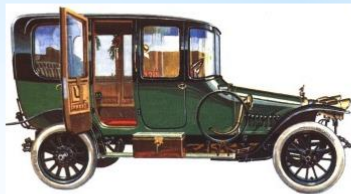
Руссо-Балт-С24-40" XIII серии с кузовом лимузин, оборудованным панорамным ветровым стеклом. 1913 г.
