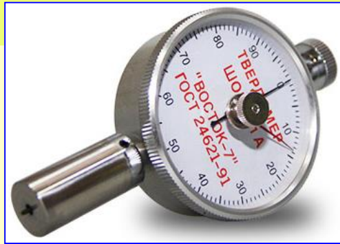
ТВР-А твердомер (дюрометр) Шора тип А с аналоговым индикатором
