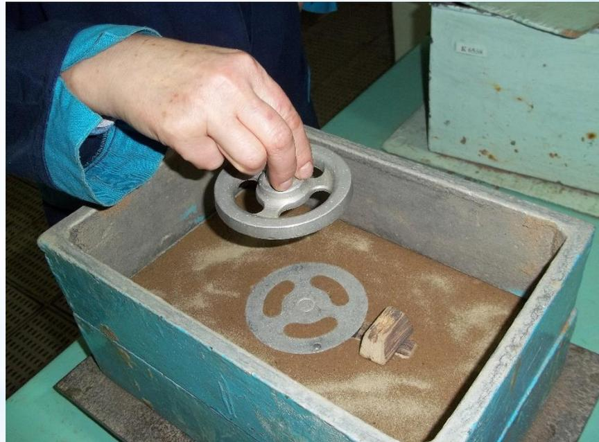
Для получения отверстий в отливках используют стержни, которые получают из стержневых смесей в стержневых ящиках
