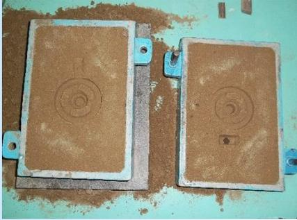
После проведения формовки из опоки извлекаются верхняя и нижняя часть разъемной модели отливки и модели элементов литниковой системы.
