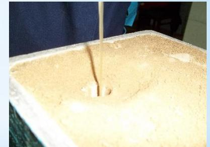
На нижнюю опоку ставят верхнюю опоку и с помощью разливочного ковша производят разливку расплавленного металла через каналы литниковой системы в форму.
