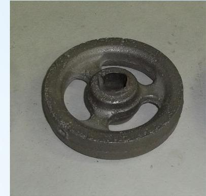
После заливки формы металл определенное время охлаждается и затвердевает, после чего форма разрушается ( выбивается ) и из нее извлекают отливку
