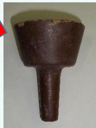
**Литниковая чаша** принимает напор струи металла и частично определяет шлак. Стенка чаши, принимающая жидкий металл, наклонена под углом  $45^{\circ}$  к горизонтальной площади для уменьшения силы удара падающей струи.
