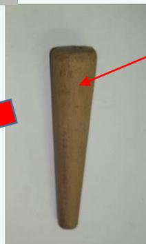
**Стояк** соединяет литниковую чашу со шлакоулавнителем. Он заполняется металлом в первый момент заливки и остается в течение всего периода литья заполненным. Скорость движения жидкого металла в стояке увеличивается сверху вниз, так как стояк делают конусным, суживающимся книзу на  $3...5^{\circ}$ .
