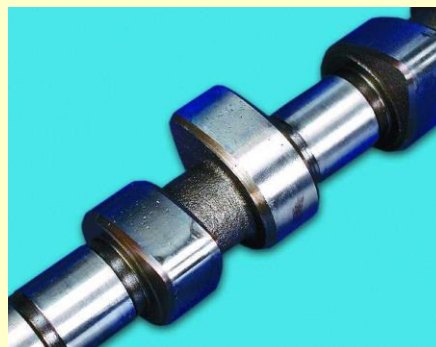
Износ кулачка и коррозия поршня
