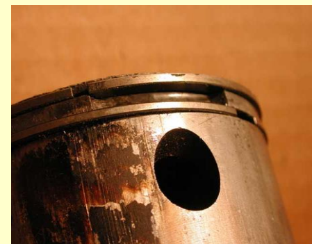
Износ кулачка и коррозия поршня
