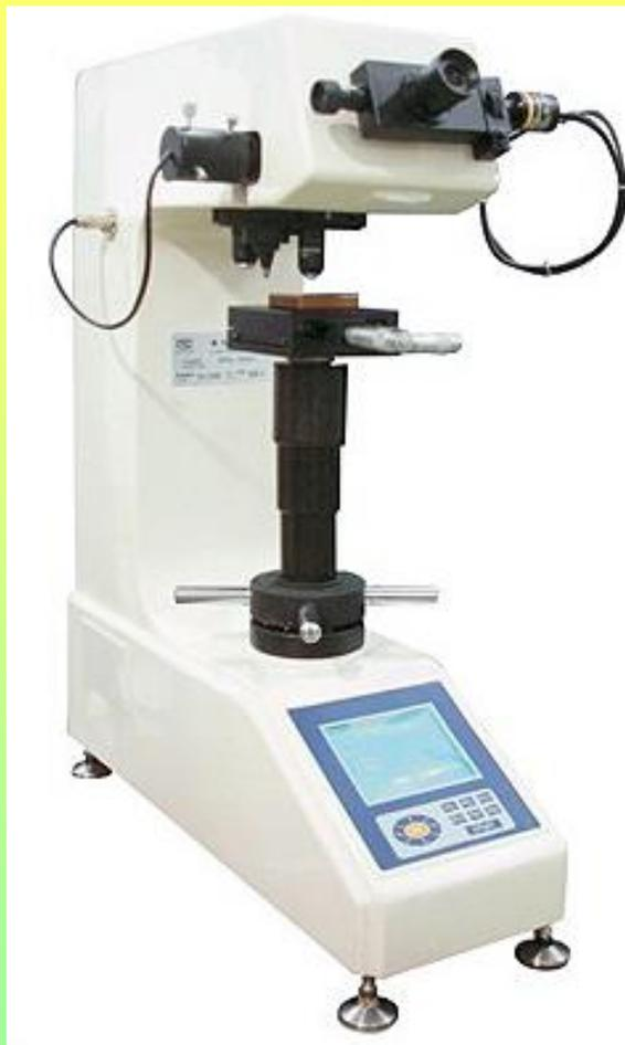
Стационарные твердомеры по Виккерсу HV-10, HV-30 и HV-50
