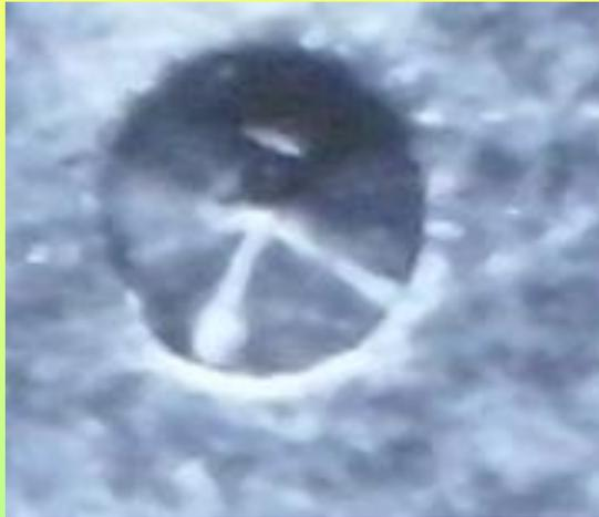
Измерение диаметров отпечатков тоже вызывает определенную проблему, поскольку по краям отпечатка всегда присутствуют навалы и наплывы.
