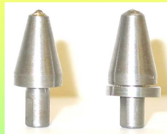
Наконечник алмазный НП для измерения твердости по методу Виккерса
