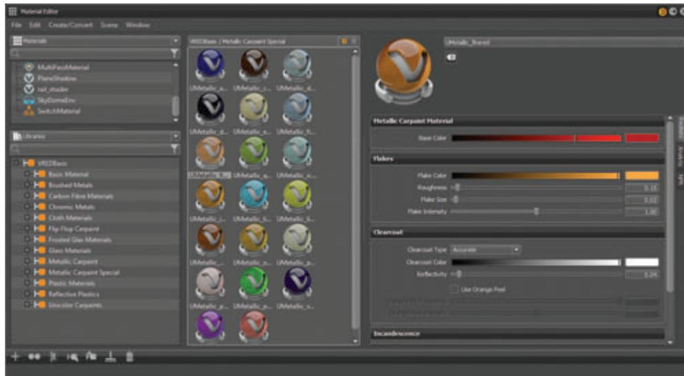
Рис. 6. Редактор материалов VRED с загруженной библиотекой базовых материалов
