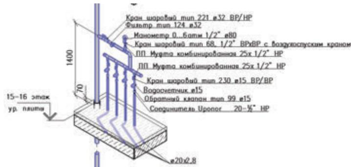
Рис. 10. Гребенка системы водоснабжения
