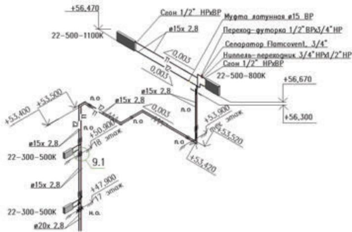
Рис. 6. Фрагмент изометрической схемы системы отопления лифтового холла
