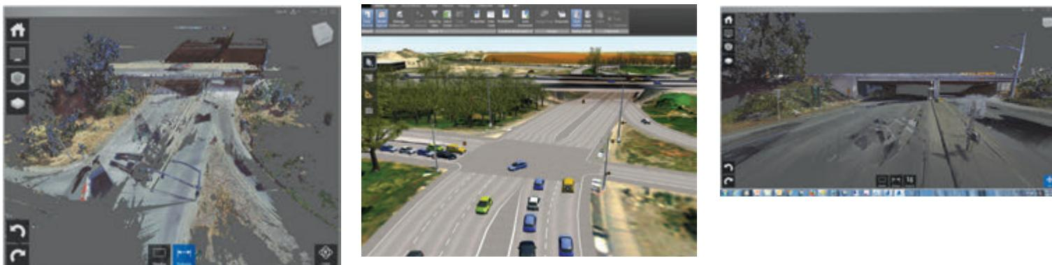
Объединение модели путепровода Autodesk InRoads с обработанными сканированными данными в ReCap
