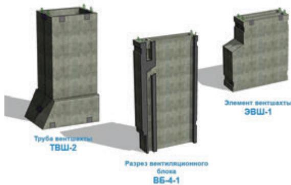
Рис. 20. Семейства вентблоков и вентшахт
