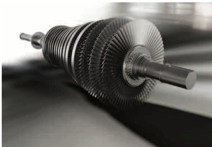
Визуализация 3D-модели ротора паровой турбины
