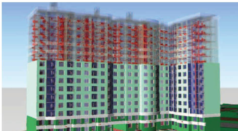
Рис. 1. Модель жилого корпуса микрорайона, содержащая в себе разделы АР, КЖ и КМ, а также внутренние инженерные сети. Инженерные сети проходили проверку на конфликты в Autodesk Navisworks
