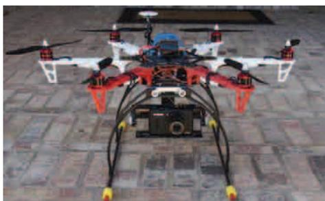
Рис. 3. Летательный аппарат, используемый для воздушного лазерного сканирования
