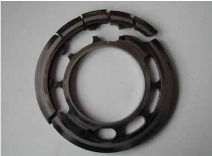
Рис. 1. Распределительный диск гидромашины, разрушившийся во время испытаний на форсированных режимах работы гидропривода
