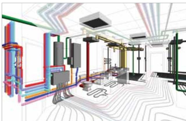
Рис. 2. Вид на коммуникации квартиры, выполненные в Revit MEP. Часть модели инженерного оборудования энергоэффективного здания, 2012. Автор – Игорь Козлов
