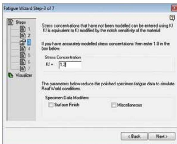
Рис. 5. Определение коэффициента концентрации напряжений и факторов несовершенства модели
