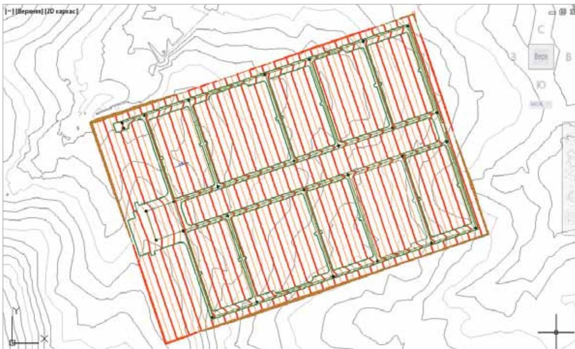
Рис. 4. Проектная поверхность после добавления структурных линий
