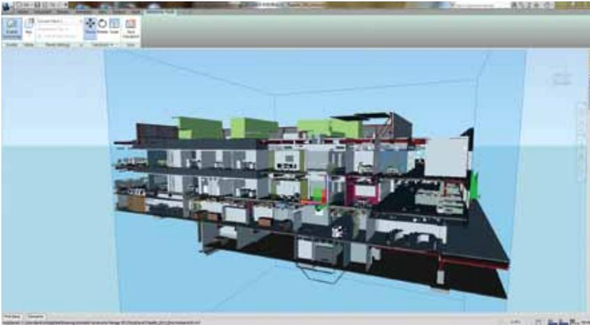
Рис. 6, рис. 7. Один из аналитических инструментов Navisworks «секущий куб»
