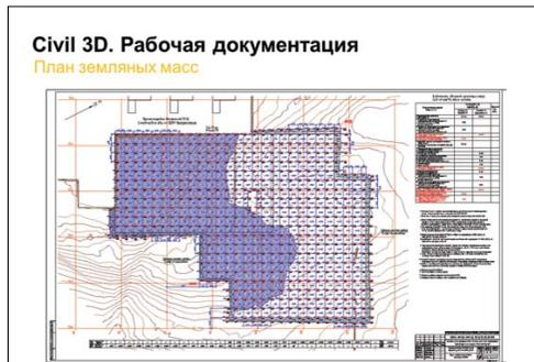
Рис. 9. Пример комплекта, выполненного для отдела генплана и дорог в Civil 3D
