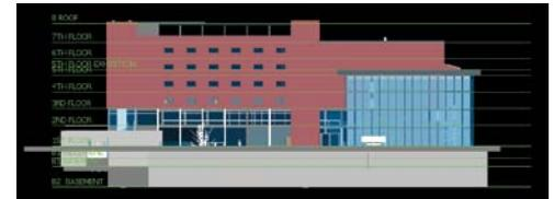
Рис. 14. Уровни появляются только в ортографическом режиме просмотра, когда плоскость экрана становится перпендикулярной относительно плоскостей уровней
