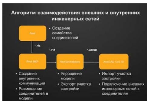
Рис. 4. Файл обмена архитектурными данными позволяет экспортировать из Revit алгоритм подключения внешних и внутренних инженерных сетей
