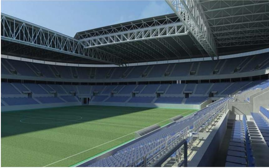
Алексей Савватеев. Проект футбольного стадиона в Новосибирске. Модель выполнена в Revit Architecture и Revit Structure, расчет конструкций в Robot Structural Analysis. НГАСУ(Сибстрин), 2011.
