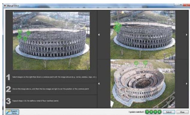
Рис. 7. Ручная простановка точек на фотографиях
