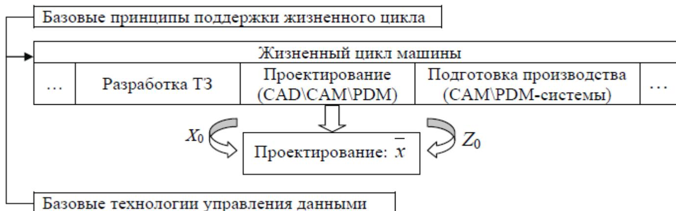
Процесс проектирования как элемент жизненного цикла машины:
