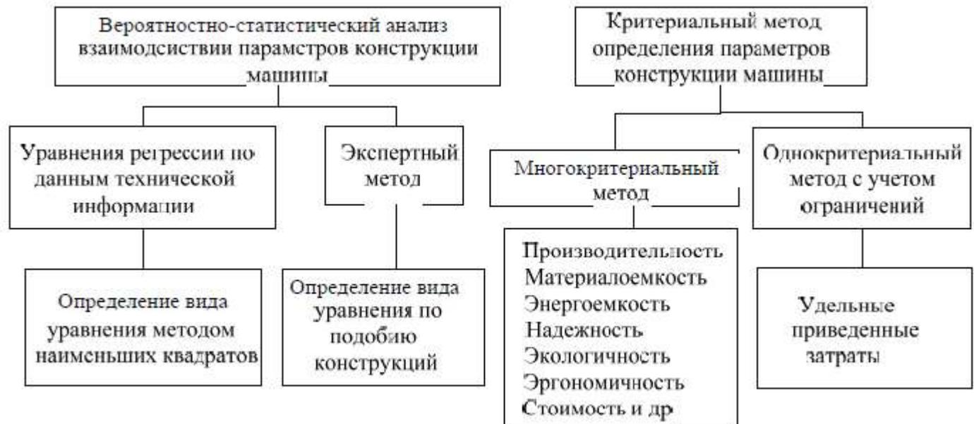
**Вероятностно-статистический метод определения взаимосвязей параметров конструкции машин реализуется по следующей схеме:**
