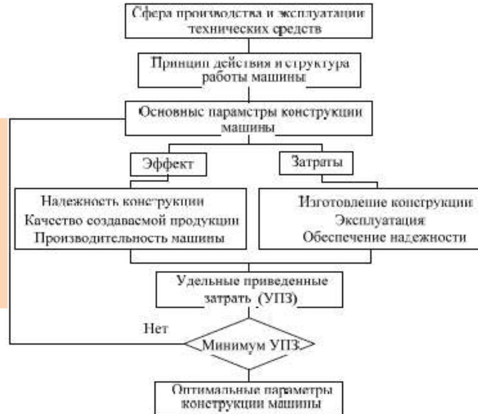
**Задача определения параметров перспективных образцов дорожно-строительных машин является типичной прогнозной задачей определения возможных изменений параметров конструкции машины**
