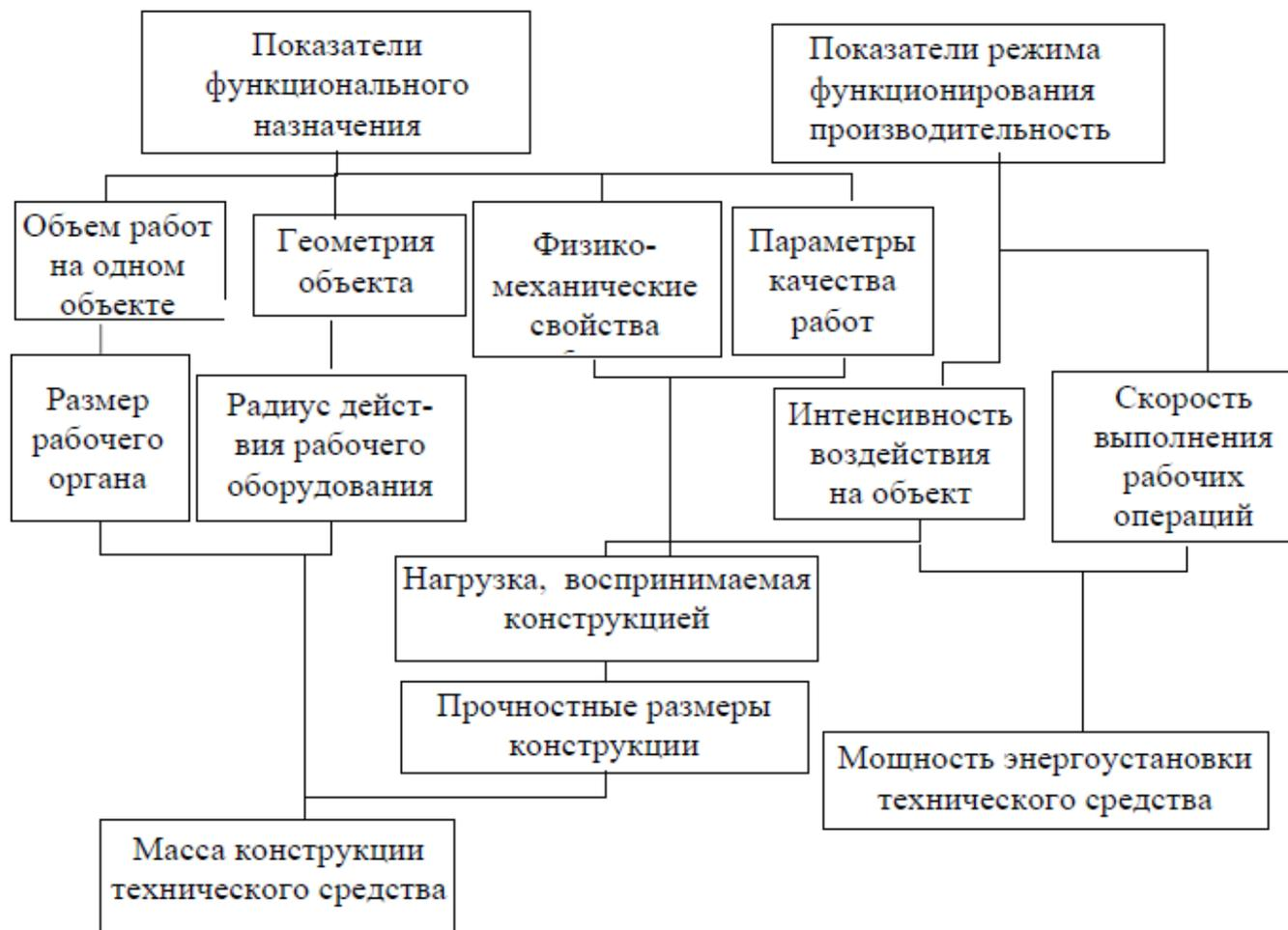
Связь основных параметров конструкции технического средства с показателями его назначения
