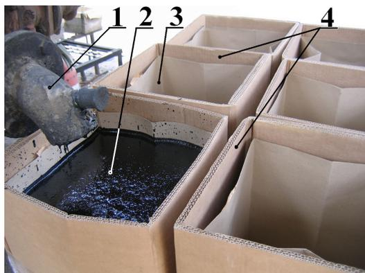
Рис. 3.3. Расфасовка горячего битума в крафт-мешки: 1 – фасовочная горловина; 2 – битум; 3 крафт-мешок; 4 – картонная форма
