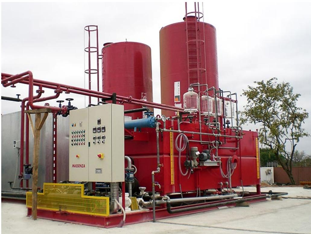
Рис. 5.9. Внешний вид промышленного эмульсионного оборудования EASY 3500 SK
