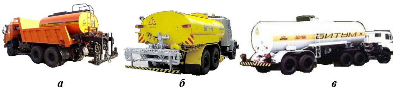
Рис. 3.2. Автогудронаторы (*а* – смонтированный на самосвале; *б* – базовый) и автобитумовоз (*в*)
