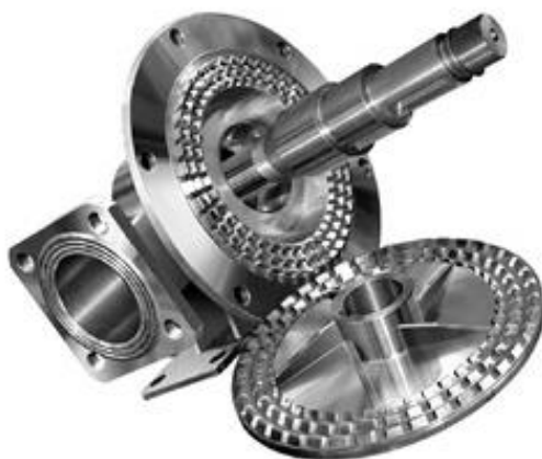
Рис. 10.12. Рабочий узел коллоидной мельницы
