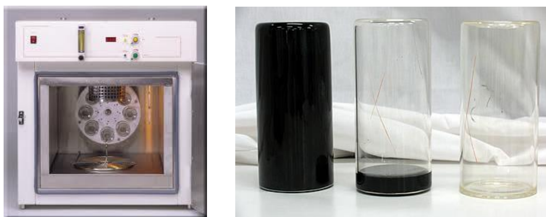
Рис. 11.6. Термостат с вращающимся стеклянным сосудом (RTFOT)
