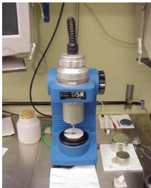
Рис. 11.2. Динамический сдвиговый реометр (DSR), работающий по схеме плоскость – плоскость
