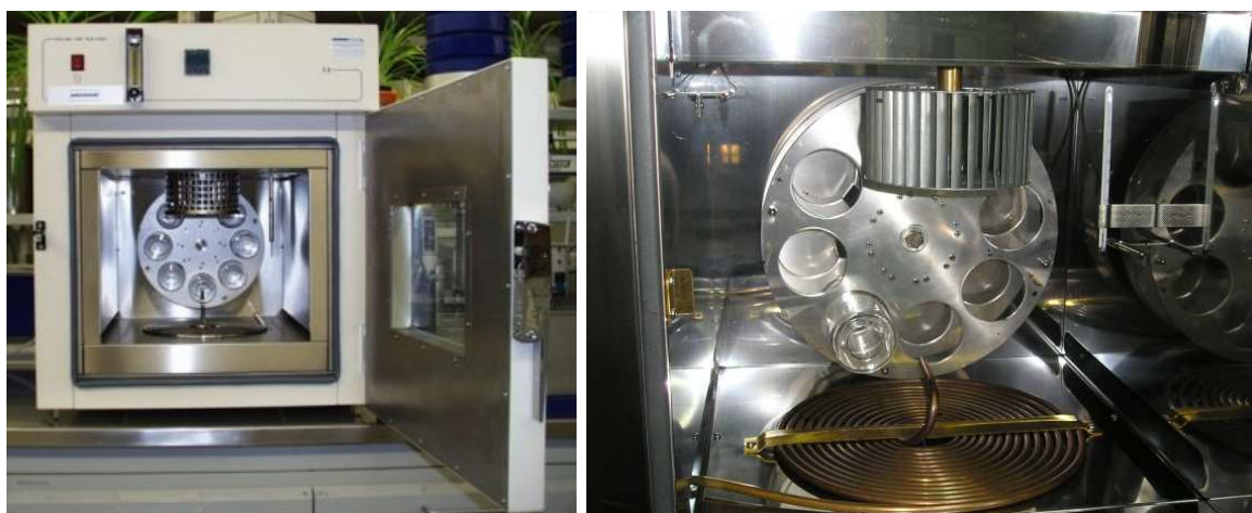
Рис. 7.9. Вращающаяся тонкопленочная печь (метод RTFOT)
