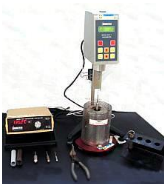
Рис. 11.1. Ротационный вискозиметр Brookfield'a
