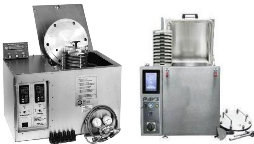
Рис. 11.7. Аппарат для старения вяжущего под давлением (PAV)
