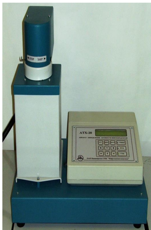
Рис. 7.4 Схема (а) и автоматический прибор (б) для определения температуры хрупкости: 1 – концентрические трубки; 2 – термометр; 3 – клинообразное устройство; 4 – термостат Дюара; 5 – пробирка; 6 – захваты; 7 – пластина с битумом
