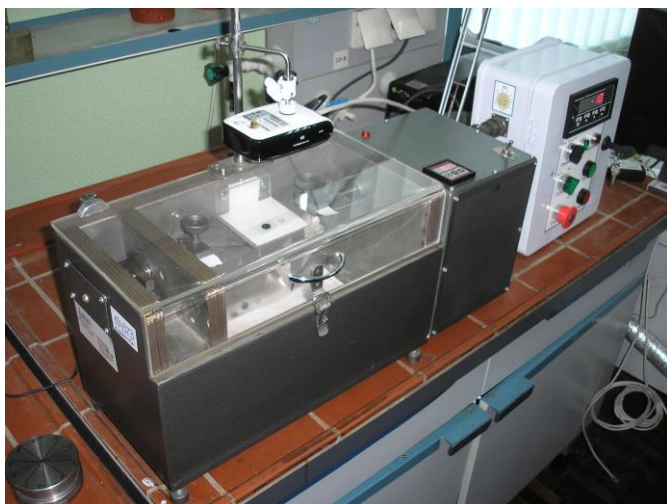
Рис. 8.10. Общий вид когезиометра «ХНАДУ – Дор’якість» и образцы после испытания на сдвиг по схеме «плоскость-плоскость»
