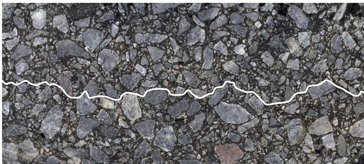
Рис. 4.8. Разрез многощебенистого асфальтобетона с огибающей поверхностью сдвига
