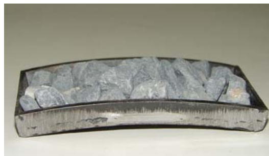
Рис. 1.5. Установка для определения полируемости щебня
