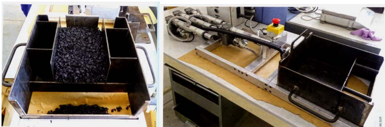
Рис. 9.2. Определение слеживаемости холодной асфальтобетонной смеси по методу фирмы «Nynas»
