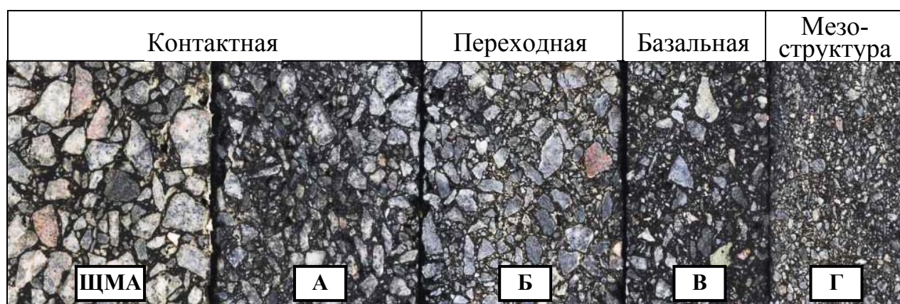
Рис. 3.2. Асфальтобетоны разных структурных и гранулометрических типов: щебеночно-мастичный (ЩМА); многощебенистый (А) с контактной; среднещебенистый (Б) с переходной; малощебенистый с базальной макроструктурой (В); песчаный (Г)
