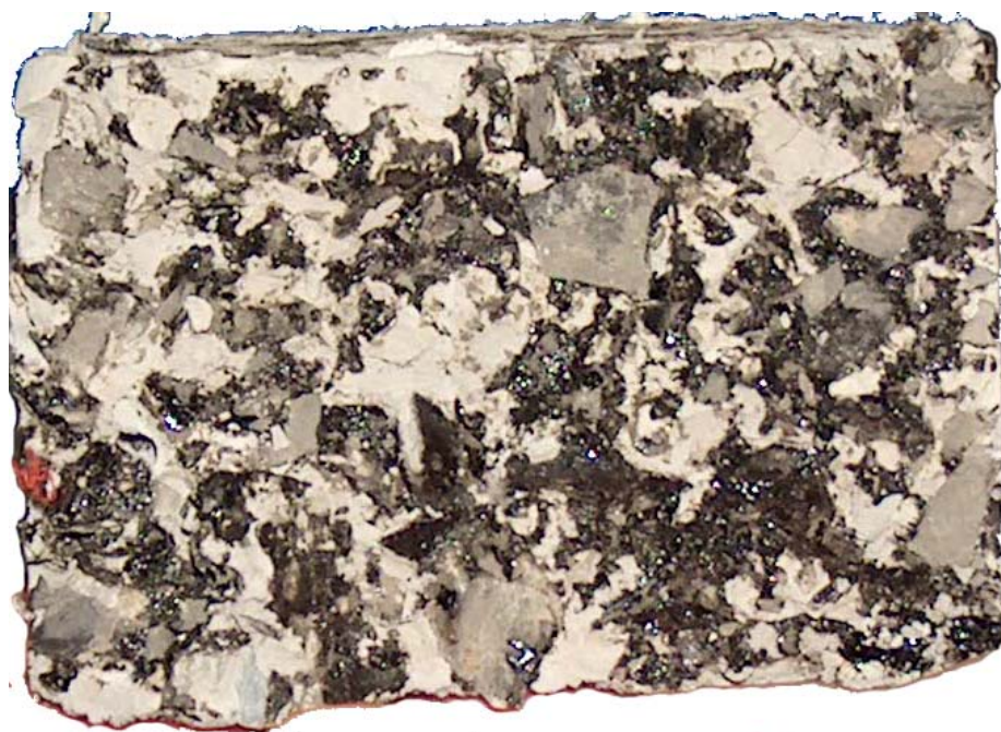
Рис. 12.1. Макроструктура асфальтобетона, пропитанного цементным тестом
