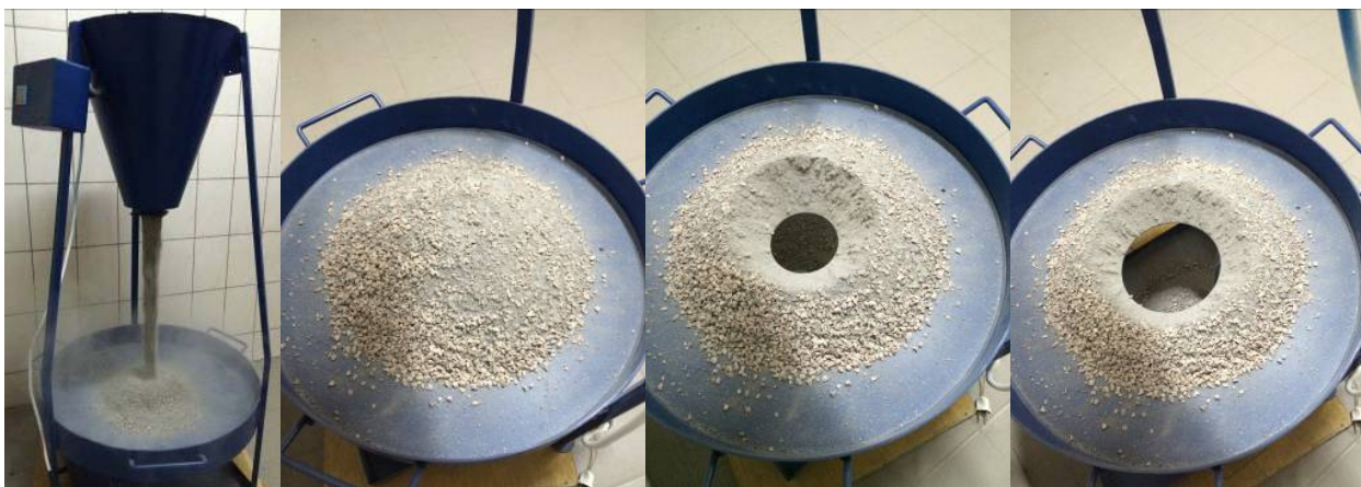
Рис. 6.3. Определение сегрегации минеральных составляющих асфальтобетонной смеси типа Б
