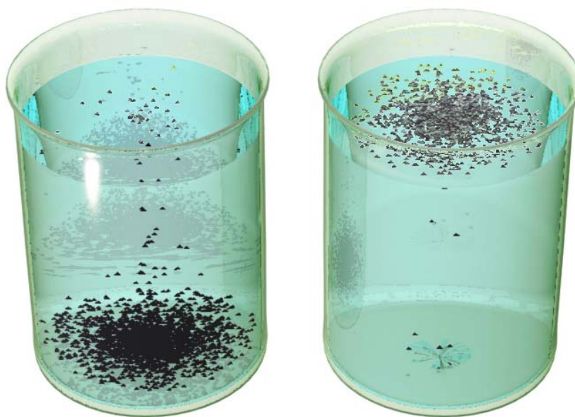
Рис. 1.11. Принцип определения степени гидрофобности активированного минерального порошка: слева – обычный, справа – активированный
