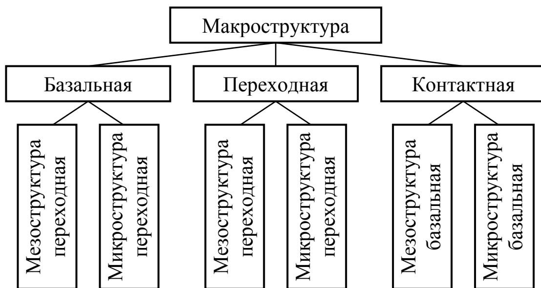
Рис. 3.3. Взаимосвязь между макро- и микроструктурой в асфальтобетонах
