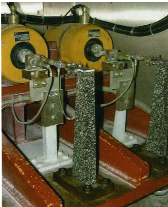
Рис. 7.3. Определение комплексного модуля упругости методом синусоидального изгиба по Европейскому стандарту
