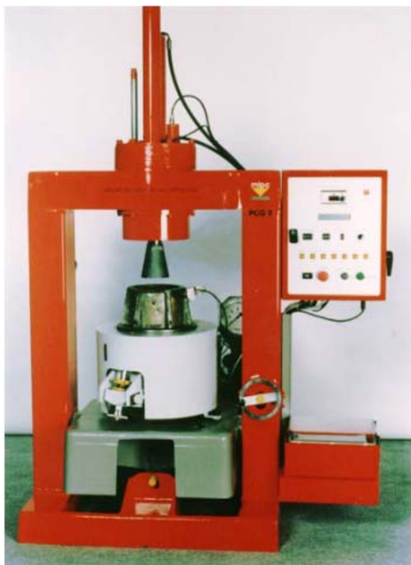
Рис. 2.2. Вращательный пресс (Франция): 1 – домкрат; 2 – станина; 3 – упорный подшипник; 4 – счетчик; 5 – верхний вкладыш; 6 – форма; 7 – корпус нагревателя; 8 – пуансон; 9 – станина; 10 – центрирующая обойма; 11 – система наклона; 12 – наклоняющий домкрат
