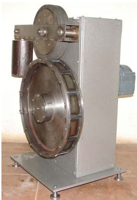
Рис. 1.5. Установка для определения полируемости щебня
