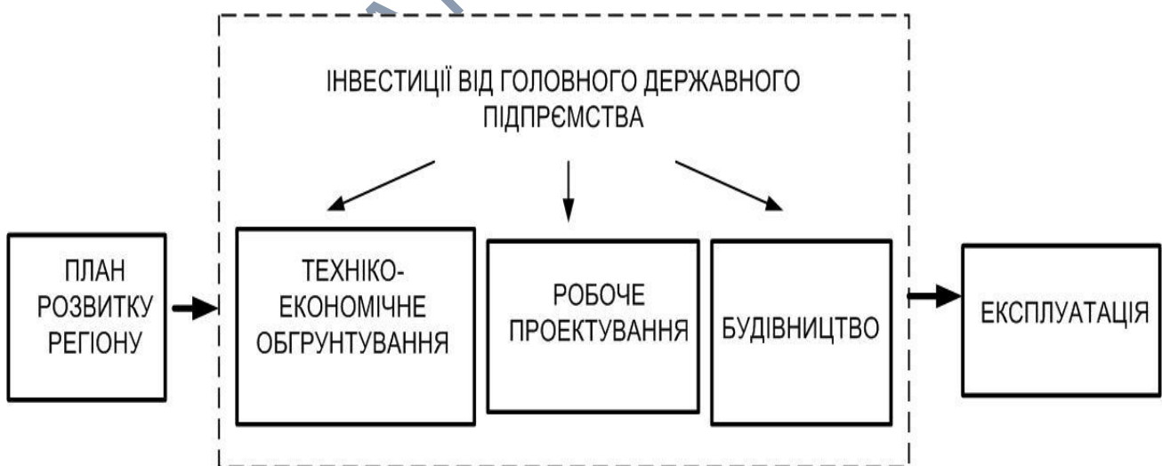
Рисунок 2.1 – Схема моделі управління життєвим циклом споруди в умовах планової економіки
