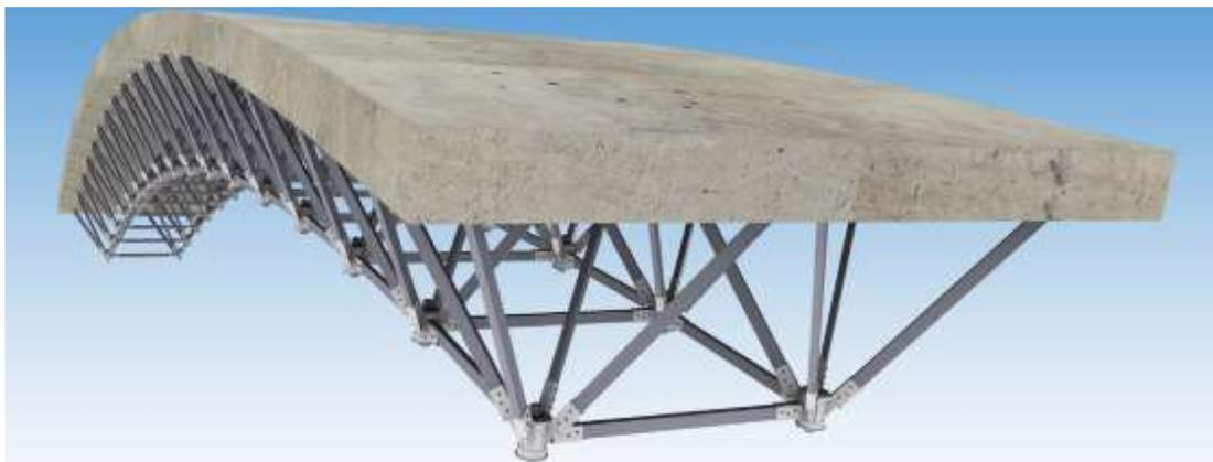
Рис. 2.26. Общий вид предлагаемой конструкции балочного пролетного строения,  $L = 24$  м
