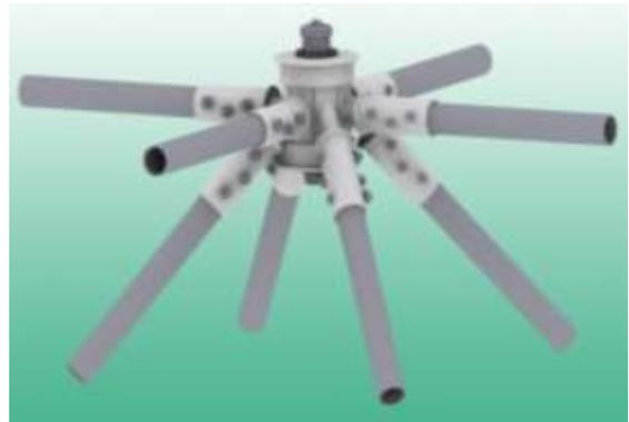
Рис. 2.32. Узел соединения стержней структурной конструкции:
