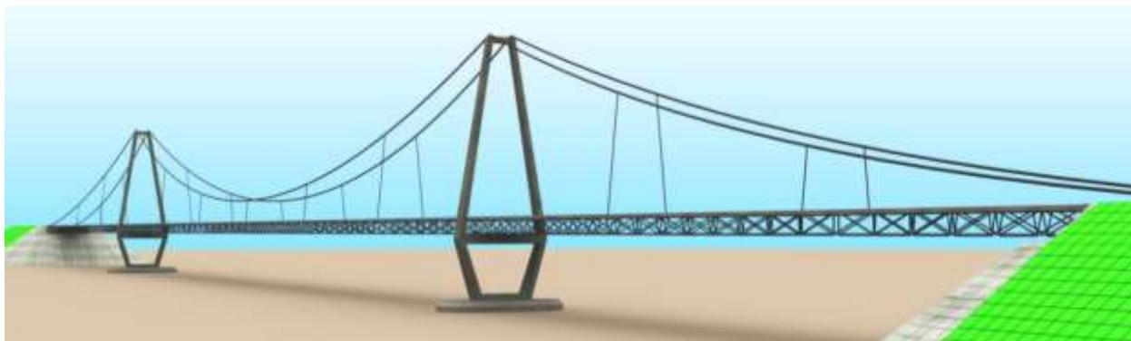
Рис. 2.44. Подвесная система сталежелезобетонного пешеходного моста
