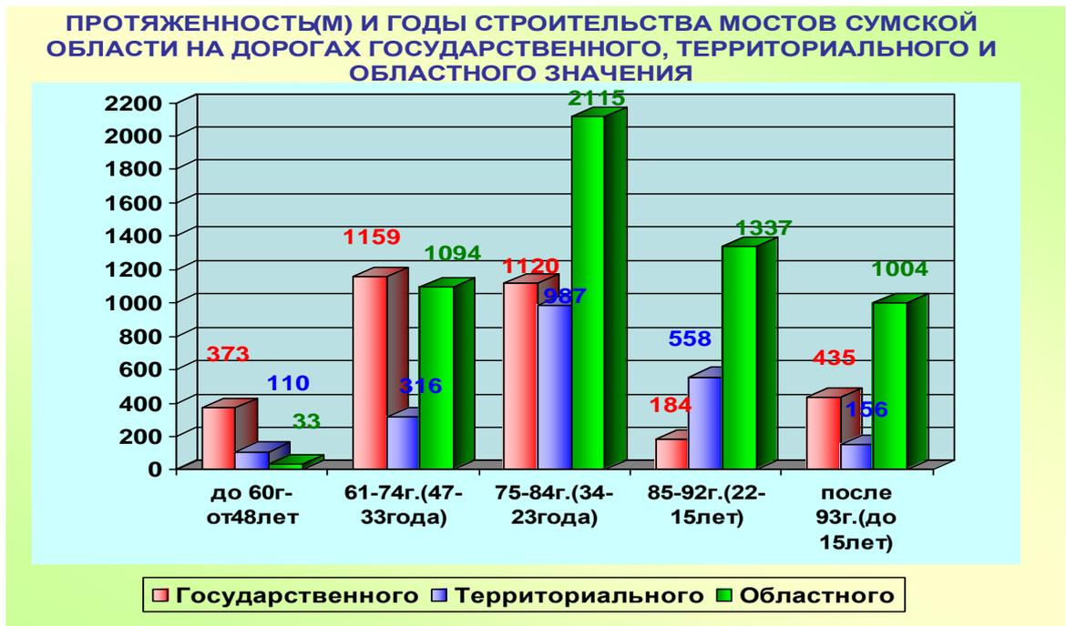
Рис. 1.5. Гистограмма распределения мостов и путепроводов Сумской области по годам строительства
