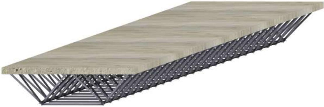
Рис.2.21. Общий вид предлагаемой конструкции балочного пролетного строения,  $L = 24$  м
