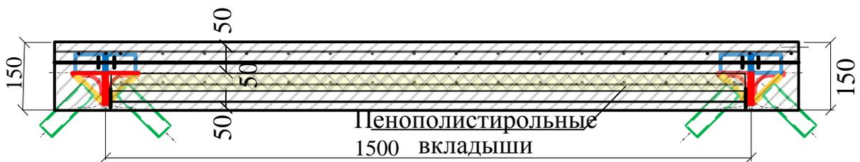
Рис. 2.39. Конструкция железобетонной плиты со съемной опалубкой
