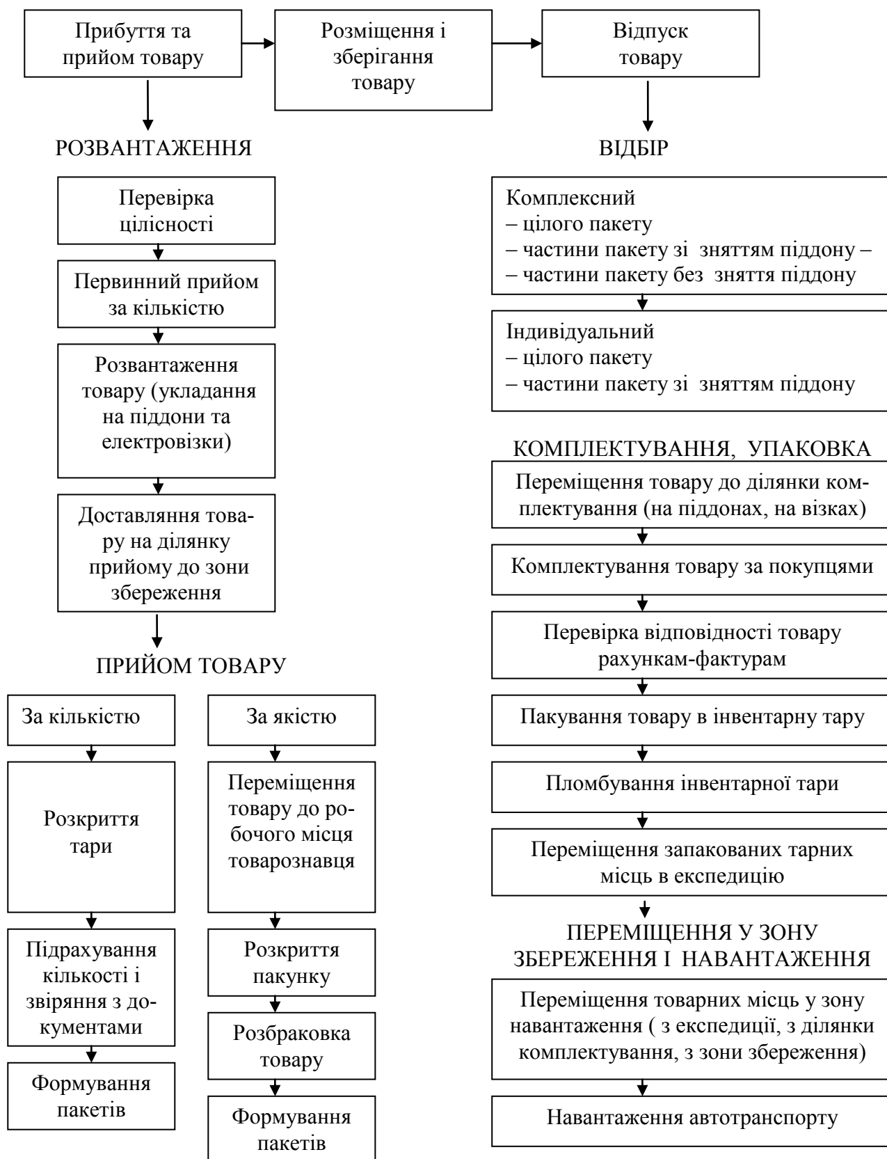
Рис. 11.3. Принципова схема технологічного процесу на складі підприємств оптової торгівлі
