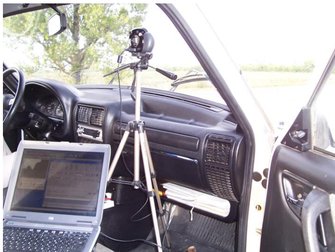
Рис. 3.18. Салон автомобіля, обладнаний КС ОЯП
