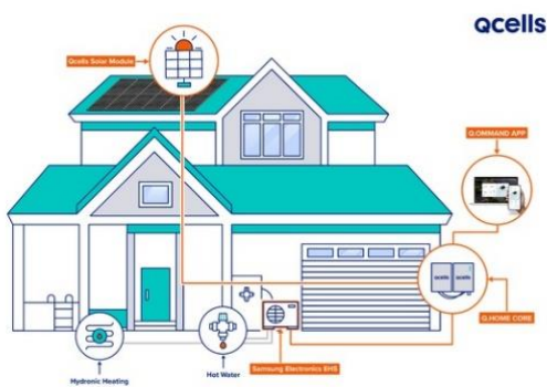
Рис. 1 Схема гібридного теплоелектропостачання
