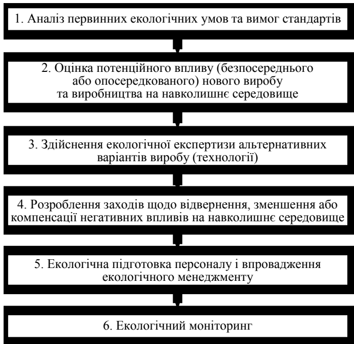
Рис. 13.9. Схема екологічної експертизи під час підготовки виробництва нових виробів
