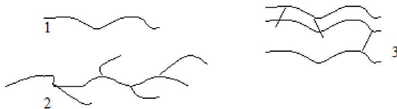
Рис. 1.1. Схематичне зображення будови полімерів: 1 – лінійних; 2 – розгалужених; 3 – сітчастих
