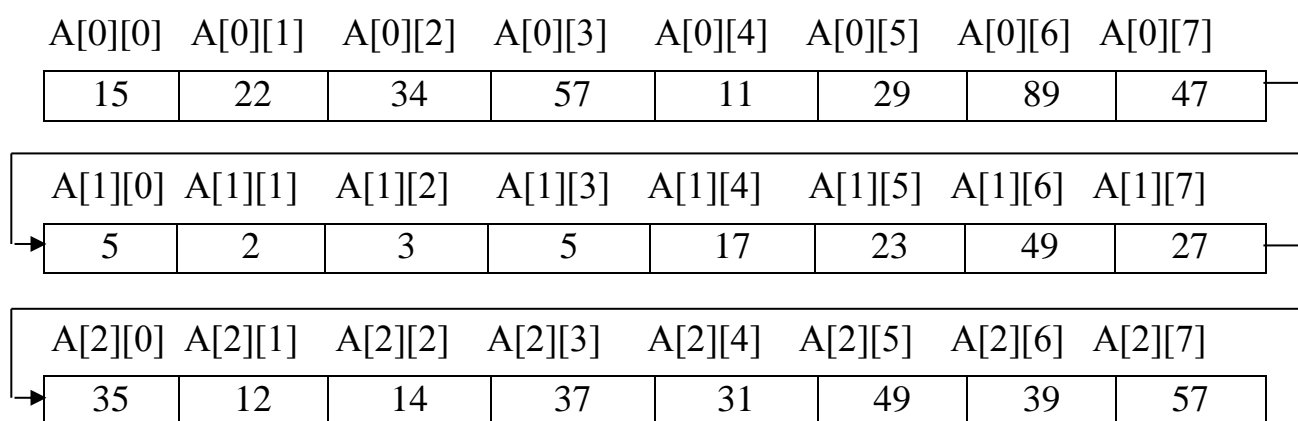
Рис. 9.1. Значения и расположение в памяти элементов массива A[3][8]
