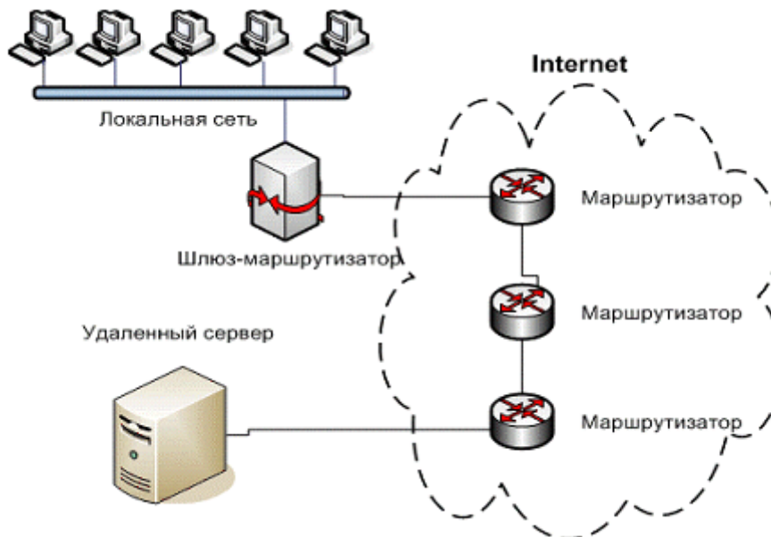
Рис. 6.5 - Схема проходження пакетів з локальної мережі до серверу
