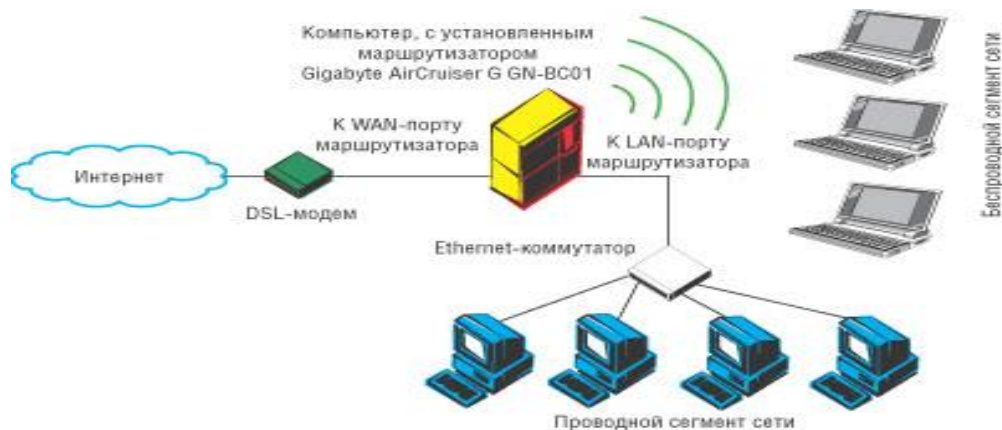
Рис. 5.2 - Використовування маршрутизатора і модему в мережі
