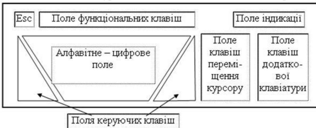
Рисунок 2.20 – Структурна схема клавіатури
