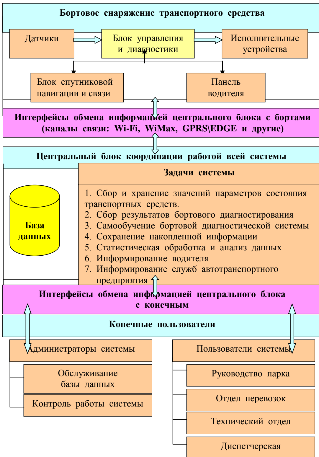
Рис. 1. Структурная схема информационной системы оперативной оценки технического состояния автотранспортных средств.
