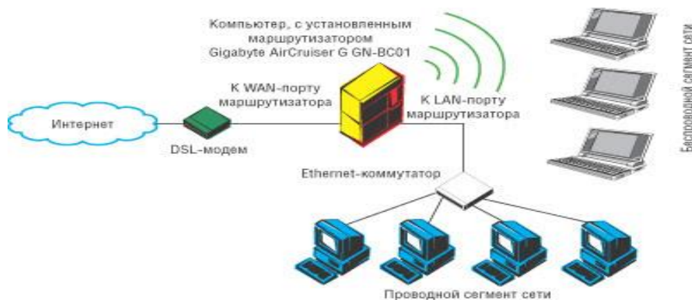
Рис. 2 - Использование маршрутизатора и модема в сети
