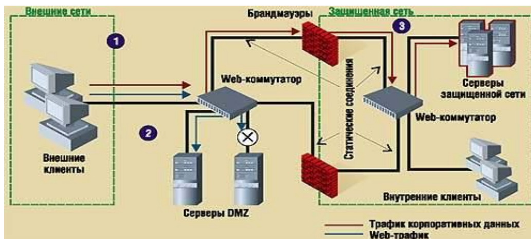
Рис. 1 - Использование брандмауэров для защиты сети
