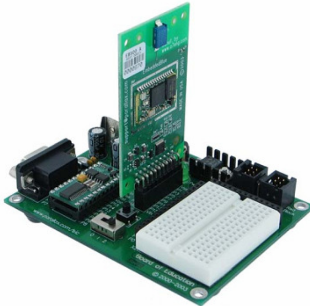
Рис. 7.3 Вид установленного на плате Bluetooth модуля
