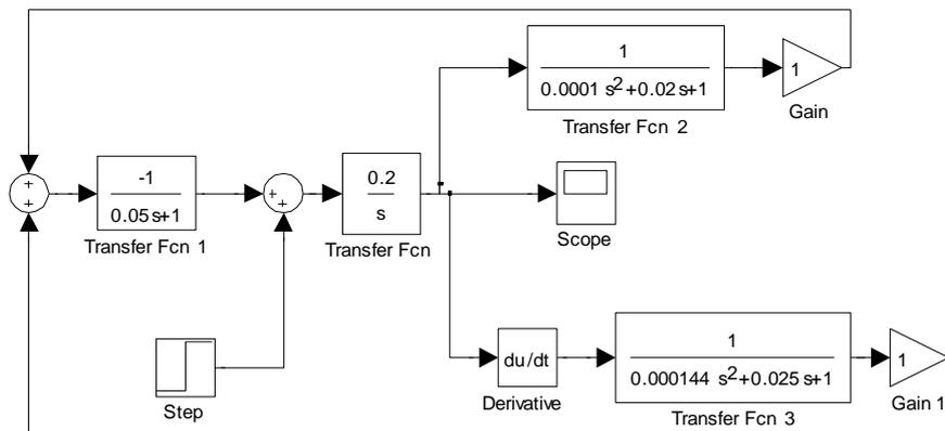
Рисунок 8.2 - Модель замкнутой системы автоматической стабилизации
