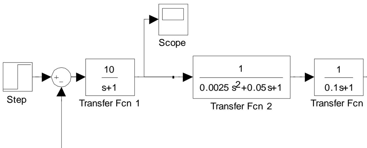
Рисунок 7.2 – Модель замкнутой системы топливоподачи ДВС с регулятором непрямого действия
