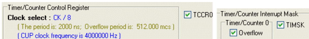
Рисунок 8. Настройка прерываний TC0
