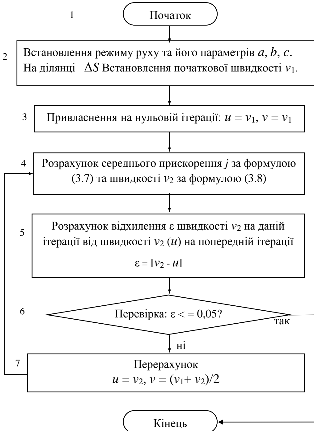
Рис. 3.2 - Схема алгоритму чисельного розв'язання рівняння (3.7) за схемою Ейлера з перерахунком
