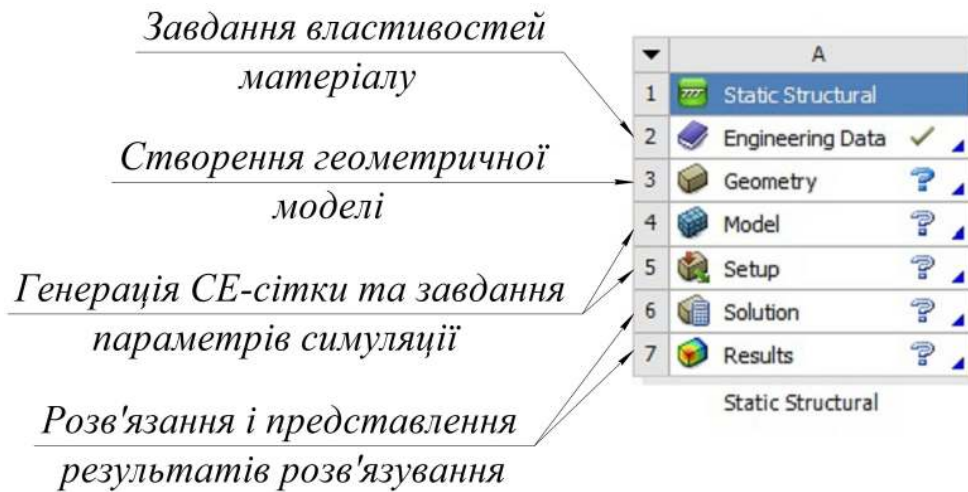
Рис. 2.5. Структура інженерного аналізу Static Structural
