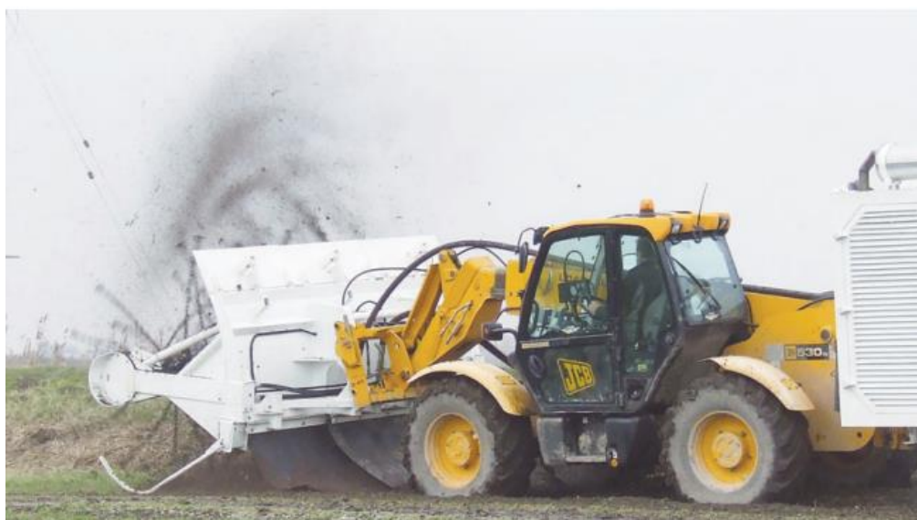
Рисунок 1 – Машина для гуманітарного розмінування на базі фронтального навантажувача JCB
