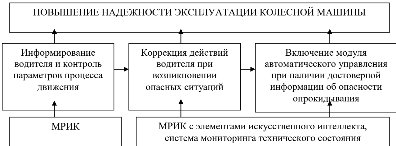
Рис. 4. Структурная схема обеспечения надежности эксплуатации колесной машины
