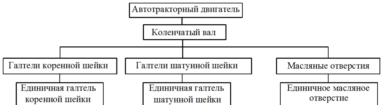
Рисунок 2. Структурная схема «дерева отказов»
