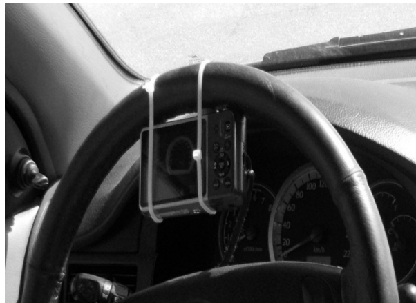
Рис. 2. Закреплённое устройство видеofиксации на рулевом колесе
