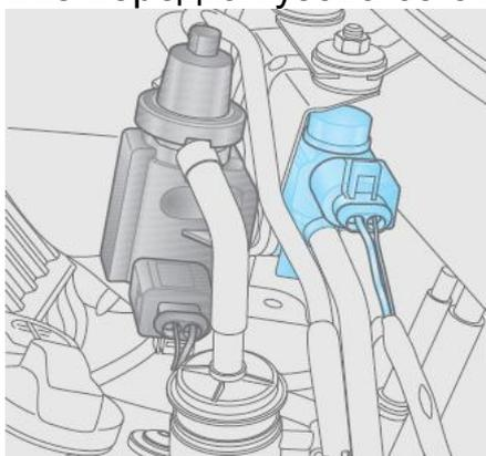
Блок управления системой впрыска дизеля формирует широтно-импульсный сигнал, определяющий величину открытия клапана, от которого зависит разрежение в вакуумном приводе механизма поворота лопаток направляющего аппарата турбокомпрессора. Регулирование давления наддува производится блоком управления системой впрыска дизеля по многопараметровой характеристике, записанной в его памяти.
