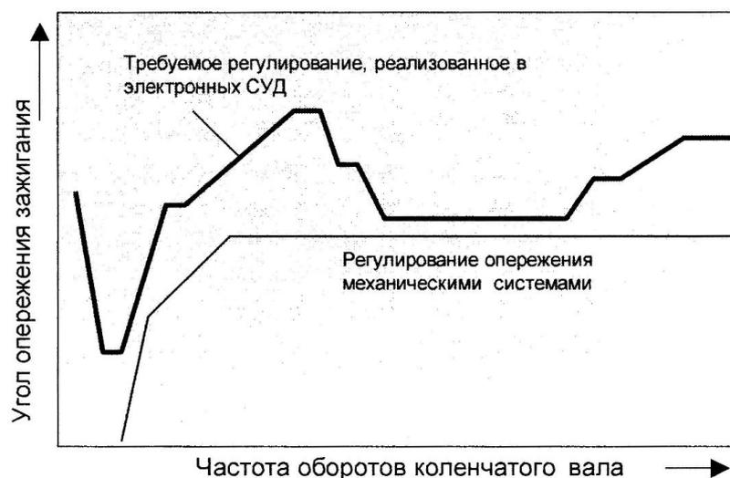
Рис. 5 - Характеристика механических регуляторов опережения зажигания
