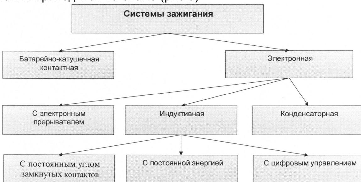
Рис 3 - Классификация систем зажигания
