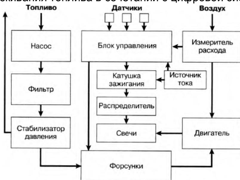
Рис. 2 - Структурная схема системы впрыскивания топлива с программным управлением
