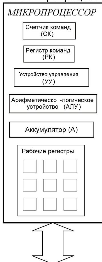
Рис. 2 - Структурная схема микропроцессора
