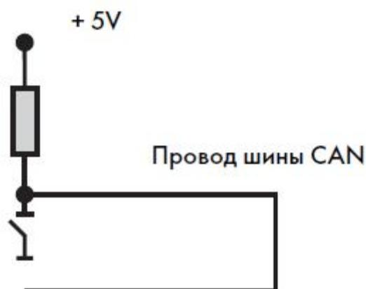
Рис. 13 Электрическая схема с выключателем
