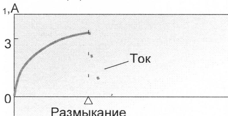
Рис.5 Изменение тока в первичной обмотке разрыве контакта прерывателя
