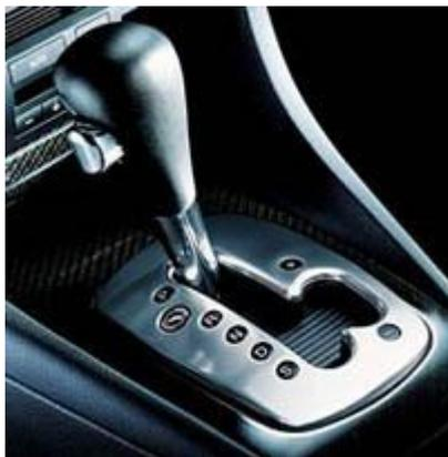
**Режим Tiptronic** осуществляется посредством рычага селектора автоматической коробки передач. Для этого в кулисе селектора предусмотрен специальный вырез со знаками «+» и «-». В ряде комплектаций автомобилей на рулевом колесе устанавливаются переключатели передач (т.н. подрулевые «лепестки»).
