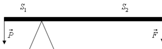
Рис. 1.6.4. Сили, що діють на плечі важеля
