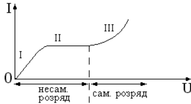
Рисунок 24. Вольт-амперна характеристика газового розряду: I – область, далека від насичення; II – область насичення; III – самостійний розряд
